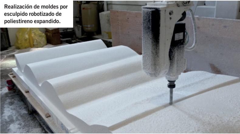
caso se partió de un modelo a tamaño natural, ejecutado en taller a base de esculpir con un robot la forma final en poliestireno expandido. Esta técnica es, hoy por hoy, la única que permite realizar este tipo de proyectos, ya que se precisa trasladar fielmente la geometría del proyecto a la obra y poder, de este modo, realizar los diferentes moldes para hacer estos paneles de GRC.
