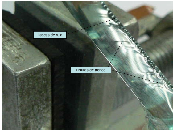
Fig.4.3. Aspecto del borde de un vidrio a "canto vivo" sin pulir.
