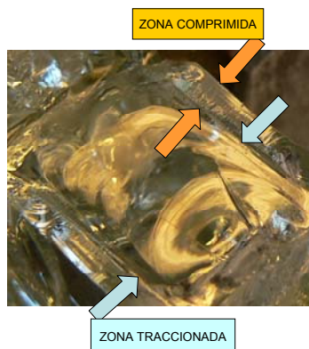
Fig.4.7. Vista del canto de un fragmento de vidrio templado fracturado donde reaprecian las diferentes zonas de tensión.
