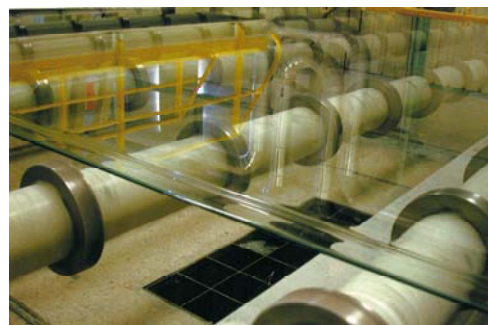
Fig. 2.6. Hoja de vidrio en la extendería, a la salida del recocido.
