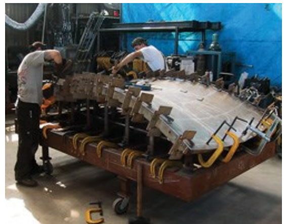
Figura 3.76: Izquierda: fabricación de estructura portante de la escultura; derecha, fabricación de paneles exteriores.
