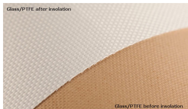
Figura 8.3: Fibra de vidrio con PTFE: a la izquierda, después de estar expuesta al sol; derecha: antes de estar expuesta al sol.
