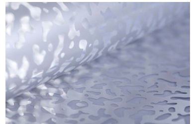
Figura 8.5: ETFE con serigrafía.
