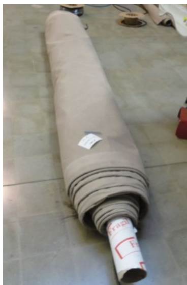
Figura 8.2: Fibra de vidrio con PTFE enrollada en una única dirección.
