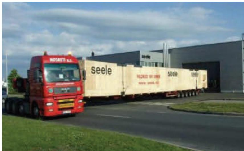
Figura 12.35: Camión de Seele Sedak, con elementos de vidrio de gran formato.
