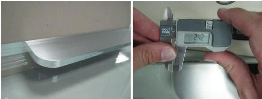
Figura 12.29: Izquierda: inserto de titanio; derecha: medición del espesor del inserto.
